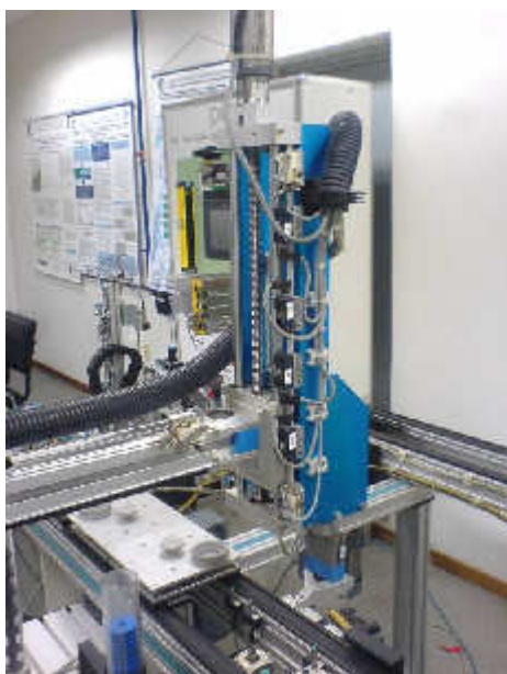
Figura 21. Eixo Z, sensores de posição e garra dedicada
