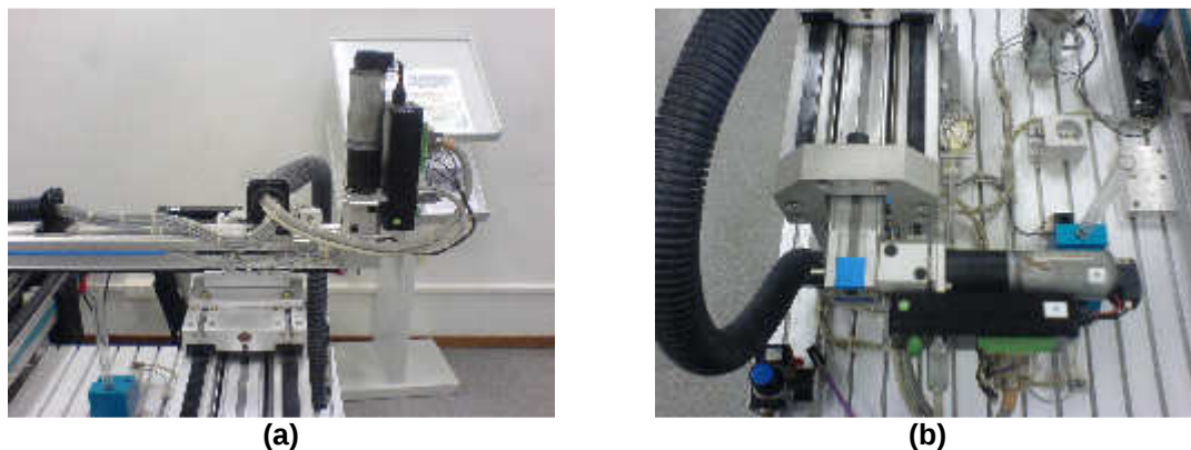
Figura 19. (a) - Acionamento do eixo y; (b) - Acionamento do eixo x
